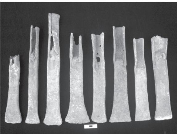
**Figura 12 – Rejas mal vaciadas y porosidad**
